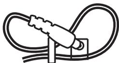
Рекомендованный способ крепления кабеля питания к корпусу приемника.
